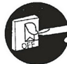
В штормовую погоду, пожалуйста, отключите первый выключатель электропитания, чтобы предотвратить кондиционер от повреждения.
