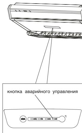
Аварийное управление применяется, если пульт ДУ утерян или вышел из строя, или разрядились элементы питания. С помощью кнопки АВАРИЙНОГО УПРАВЛЕНИЯ (MANUAL), расположенной на панели управления внутреннего блока, можно выбрать режим ОХЛАЖДЕНИЯ (COOL) или АВТОМАТИЧЕСКИЙ режим работы кондиционера (AUTO). Нажимая эту кнопку, выберите режим работы кондиционера в следующей последовательности: АВТОМАТИЧЕСКИЙ, ОХЛАЖДЕНИЕ, кондиционер ОТКЛЮЧЕН, снова АВТОМАТИЧЕСКИЙ и т.д.
