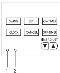
1. При нажатии кнопки LOCK (БЛОКИРОВКА) все текущие настройки и кнопки пульта ДУ блокируются. Пользуйтесь кнопкой LOCK для предотвращения случайного изменения настроек кондиционера. Для отмены функции блокировки повторно нажмите кнопку LOCK.
