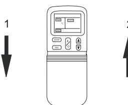
1 – Снимите крышку, сдвинув ее вниз
