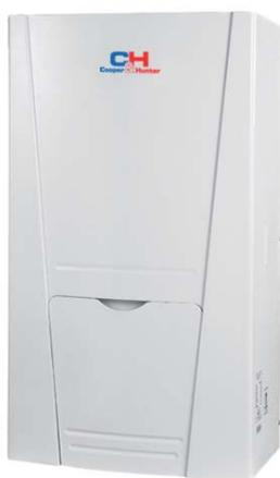
В пластинчатый теплообменник подается оптимальное количество хладагента, позволяющее нагреть воду до невысокой или умеренной температуры (20-55°C), или охладить воду (7-25°C). Резервный электронагреватель (3 или 6 кВт) позволяет системе работать даже в экстремальных условиях (неисправность наружного блока, наружная температура до -15°C). Установленные в гидро модуле датчики температуры, позволяют точно контролировать температуру воды.
