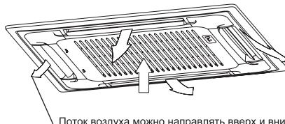
При включении этой функции направляющая заслонка будет автоматически покачиваться вверх-вниз. При отключении функции заслонка остановится в фиксированном положении. Угол покачивания заслонки на каждой стороне кассеты составляет 30°С. При отключенном кондиционере (в том числе, если задано время включения кондиционера по таймеру) кнопка SWING не работает.
