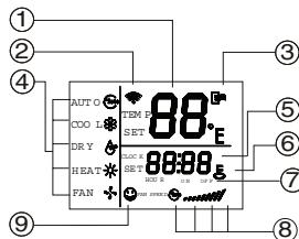
1. Индикатор температуры (TEMP): Показывает установленную температуру во всех режимах кроме режима вентиляции (FAN). Для изменения установок используется кнопки увеличения температуры (ADJUST↑) и уменьшения температуры (ADJUST↓).
