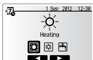
Выбор режима для автоматической работы по таймеру
