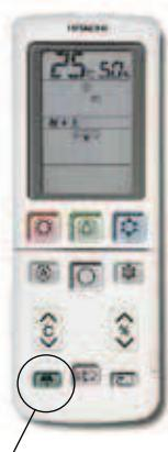
В режиме охлаждения, обогрева и т.п. нажмите кнопку функции Eco-sensor на пульте дистанционного управления.
